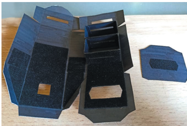
Rys. 4. Elementy spektroskopu: a) model gotowy do sklejenia, wycięty kwadrat stanowi otwór dla detektora, sześciokątny jest miejscem na siatkę dyfrakcyjną przyklejoną od zewnętrznej strony, za którą znajduje się ścianka; b) widok szczeliny o grubości około 150 \mu\text{m} (obliczone na podstawie zdjęcia przy użyciu programu ImageJ Fiji [5]); c) aparat telefoniczny przyłożony do otworu na detektor
